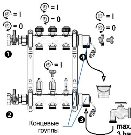
Закройте шаровые краны ①+②. Подключите шланг для наполнения и промывки к сливному крану концевой группы ③ подающего патрубка; сливной кран ④ обратного патрубка должен быть полностью открыт!
