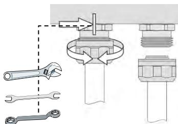
Удерживая гайку на выходе коллектора гаечным ключом SW24, закрутите накидную гайку ключом SW 30 (момент затяжки 25-30Нм). Максимально допустимый момент затяжки применяемых компрессионных фитингов не должен быть ниже указанных значений.
