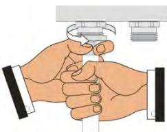
Закрутите вручную накидную гайку. Пластиковая, медная или металлопластиковая труба должна быть вставлена при этом до упора.
